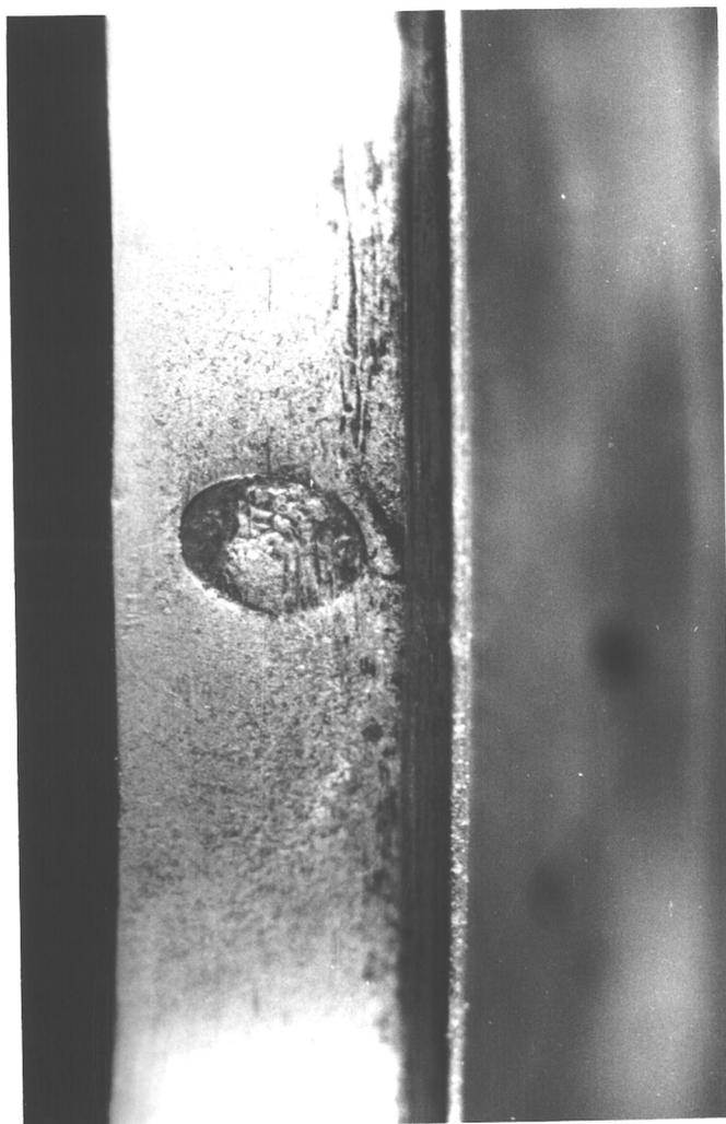
Fig.06 Détail d'un poinçon sur le bord de la coupe
