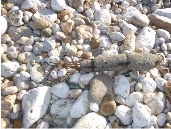
Sur l'estran, armatures de 45cm à 5m en contrebas du dans les débris à l'arrière du bloc 2018-M1-B-18-0
