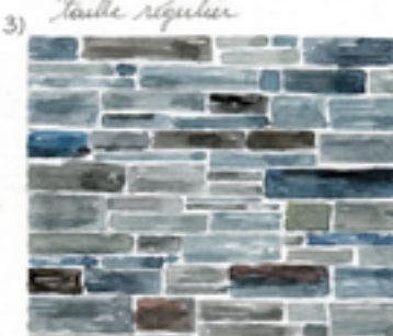
appareillage en pierre de schiste assisés.
