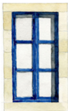
Fenêtre à 2 vantaux, 6 carreaux, en bois peint.
