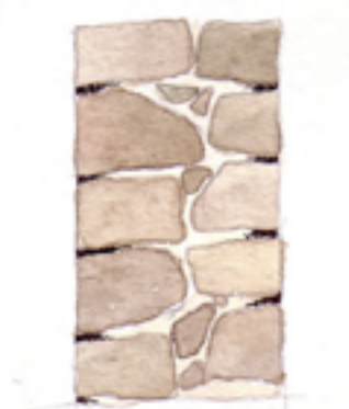
Joints fins affleurant le parement
