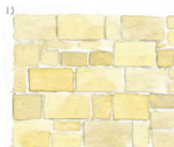
appareillage en pierre de taille avec joints réguliers
