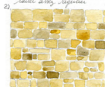
appareillage en moellons avec joints réguliers
