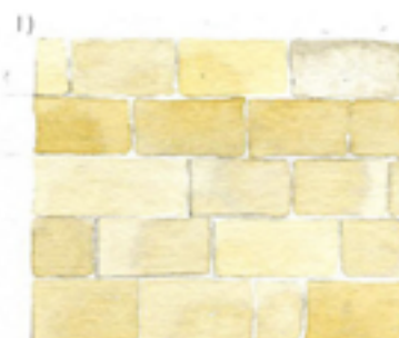
appareillage en pierre de taille régulière
