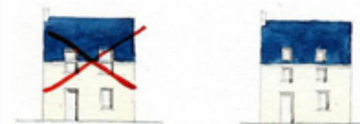
Ce style de fenêtre pourra être remplacé par 2 fenêtres distinctes (1 dans la couverture et 1 dans la façade), ou par une fenêtre soit entièrement en façade soit entièrement en couverture.
