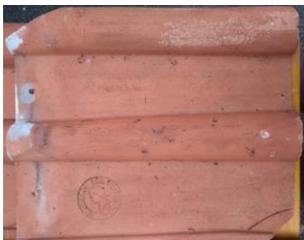
Tuile double romaine estampillée, portant deux trous de fixation et une rainure de coin pour faciliter l'écoulement des eaux de pluie. Les tuiles Browne et principalement Colthurst (ultérieurement Colthurst & Symons) sont les deux seuls types de tuiles anglaises trouvées en Bretagne.
