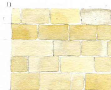
1) appareillage en pierre de taille régulier
