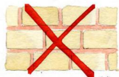
La couleur du joint ne s'accorde pas avec celle de la pierre.
