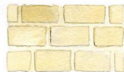
la couleur du joint est en harmonie avec celle de la pierre.
