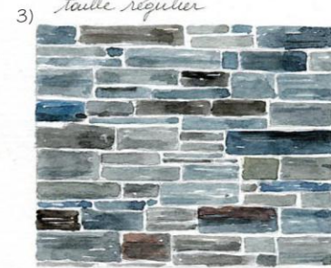
3) appareillage en pierre de schiste assisée.
