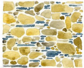
appareillage de moellons de granite et pierres de schiste, non assisés.
