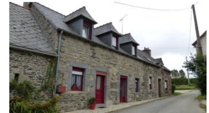
Proscrire PVC et les menuiseries a un seul carreau, les enduits ciment, les lucarnes disproportionnées
