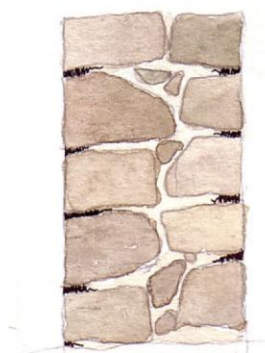
Joints fins affleurant le parement
