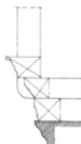
schéma de l'encorbellement du premier étage
