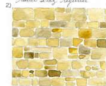
appareillage en moellons avec joints réguliers
