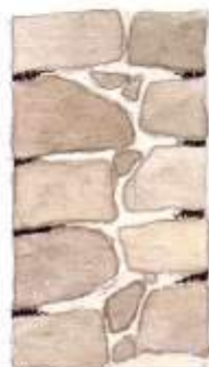
Joints fins affleurant le parement.
