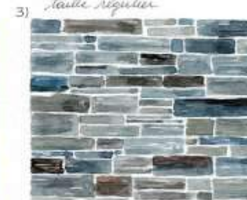
appareillage en pierre de schiste assisée
