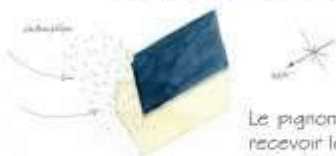
L'ardoise impose une pente minimum.
