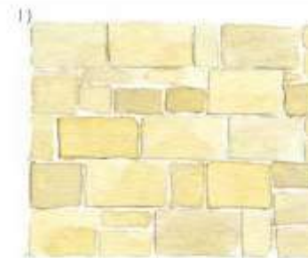
appareillage en pierre de taille avec joints réguliers
