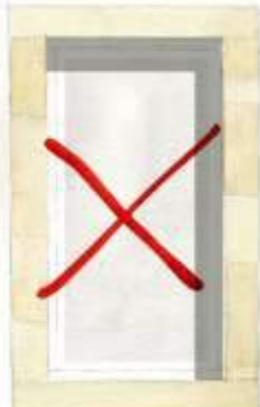
1 seul vantail à profil épais en plastique blanc. À éviter.
