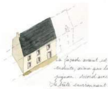
L'encadrement de la fenêtre est en saillie par rapport au reste du mur. Celui-ci était donc destiné à être enduit.
