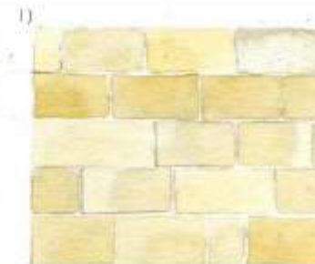
appareillage en pierre de taille régulière
