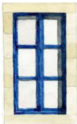
Fenêtre à 2 vantaux, 6 carreaux, en bois peint.
