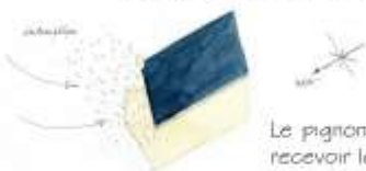
L'ardoise impose une pente minimum.
