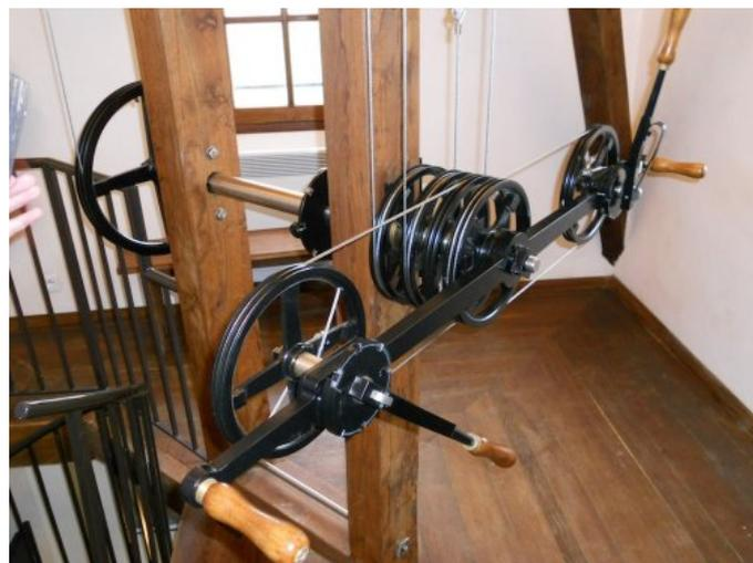
Figure 2 Maquette du télégraphe an VIII ayant appartenu à Durant, premier directeur à St Malo St Servan (Musée de la poste) (régulateur incliné, signal en préparation) (à gauche)
