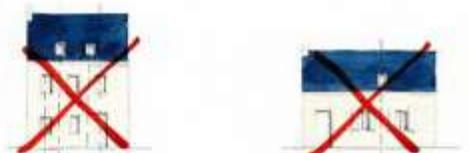
Les fenêtres de toit ne sont pas axées avec les ouvertures existantes en façade. La composition n'est pas harmonieuse.
