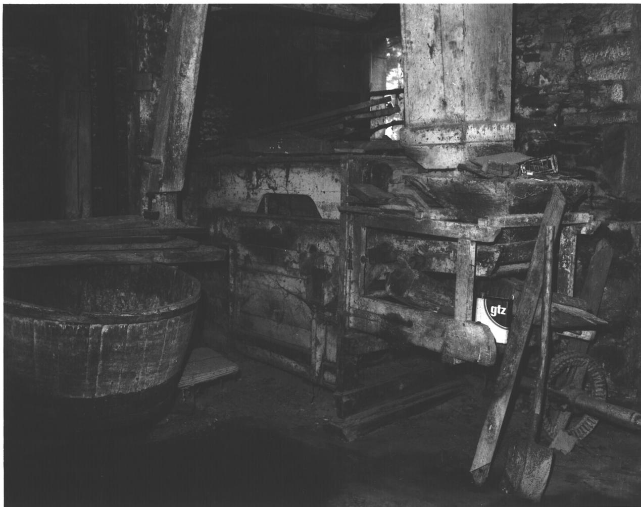
Fig.8 Vue d'un coffre d'une paire de meules
