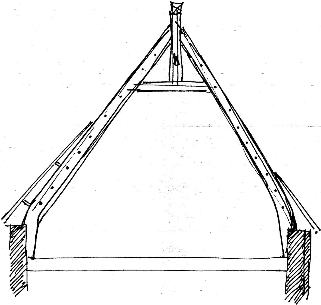
schéma d'une ferme : "upper-cruick".
